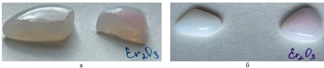
Рисунок 1. Фото образцов после доводки: а – при 750 °С, 180 мин.; б –800 °С, 120 мин.
